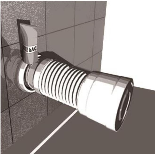
**1** Raccorder la pipe extensible sur la canalisation au sol ou au mur.
